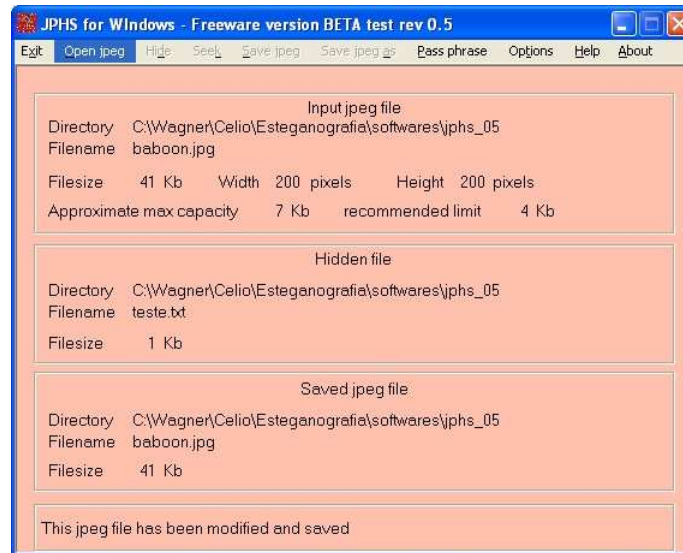
Figura 2.14: Tela após o processo de esteganografia. O arquivo teste.txt está escondido dentro da imagem baboon.jpg .
