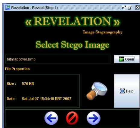
Figura 2.9: Passo 1 da decodificação do arquivo escondido na imagem bitmap.bmp. A imagem modificada é escolhida.
